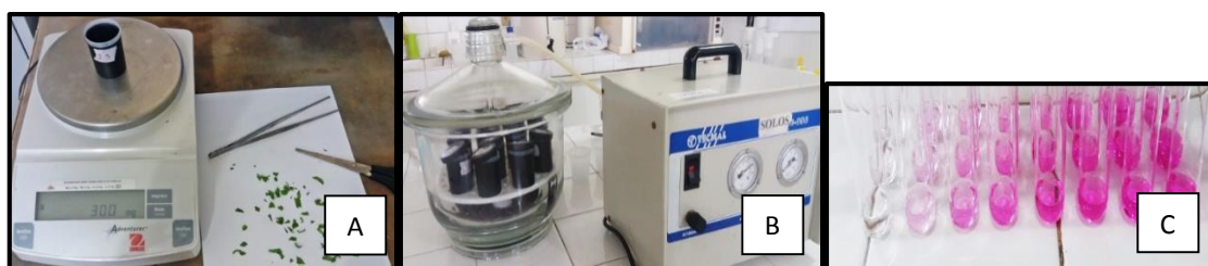
Figura 3. Análise da enzima redutase do nitrato em matéria fresca de folhas de alface. Peso de fragmentos de folhas de alface (A), frascos com meio de incubação em infiltração a vácuo (B) e curva padrão preparada com soluções diluídas de NO 2 - (C). UNEMAT, Alta Floresta (MT), 2018.
